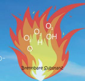
**Chemischer Prozess:** Wenn das Aerosol auf die Flamme trifft, wird durch die Bindung der freien Radikale die Kettenreaktion des Verbrennungsprozesses unterbrochen. Die Flamme erlischt.
