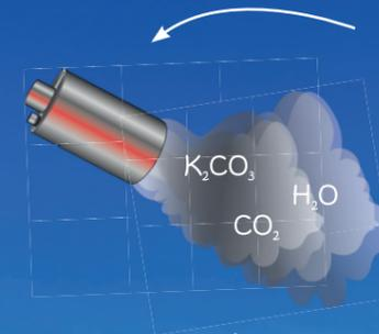
Ein Aerosol ist ein Gemisch aus einem Gas und feinsten flüssigen oder festen Partikeln. Beim Auslösen eines Aerosol-Löschgenerators wird das Aerosol auf Basis von Kaliumcarbonat erzeugt und freigesetzt.
